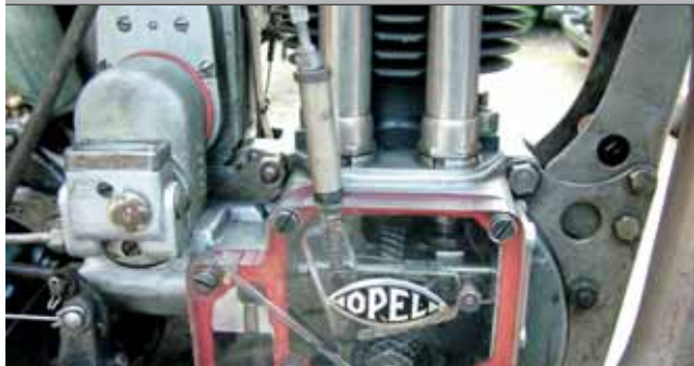
Kennt man sonst nur von Ducati: Freie Sicht auf den Nockenwellenantrieb auch bei der Opel Motoclub 500 Supersport von 1929
