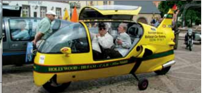
So wie dieses, in der Schweiz gebaute Peraves Ecomobil würden vermutlich heute Ernst Neumann Neanders Fahrmaschinen aussehen. Die „Flieger“ verfügen über 1,2 Ltr.- BMW - Motoren mit 130 PS und sind ebenso schnell wie teuer
